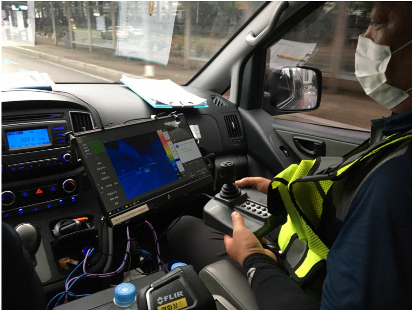
[그림 106] 차량을 이용해 열화상 카메라로 관로 점검 중인 노동자
